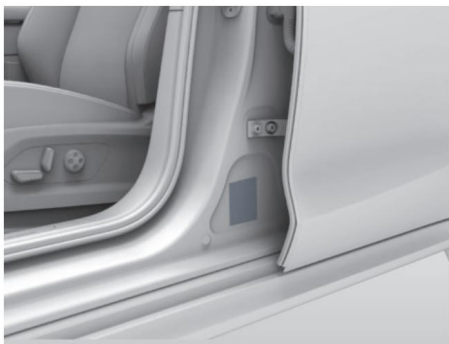
На фото: табличка с указанием давления в шинах расположена под средней стойкой слева.
