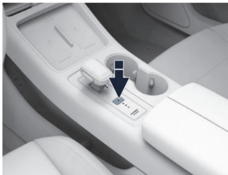
Иллюстрация: передача P выключает автомобиль (форму рычага переключения передач см. на реальном автомобиле)
