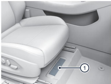
Иллюстрация: Расположение VIN кода автомобиля (расположение на изображении приведено только для справки, для конкретных условий обратитесь к реальному автомобилю)
