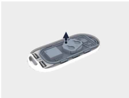
Изображение: Извлеките плату дистанционного ключа.
