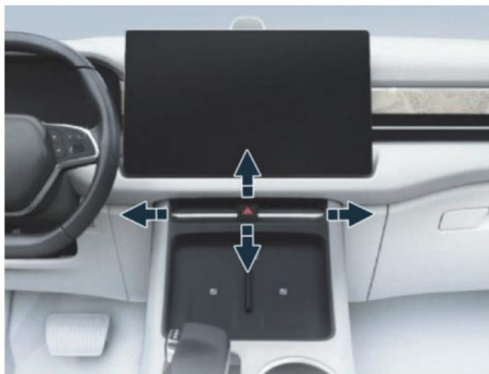
Иллюстрация: Регулировка воздушного отверстия в центральной части переднего ряда (в разных версиях имеются различия, см. конкретный автомобиль)
