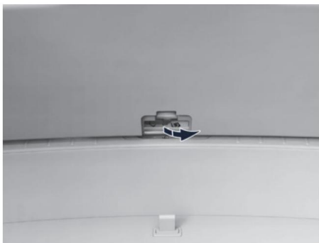
На фото: аварийный выключатель багажника.
