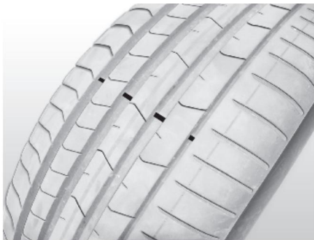
На фото: след износа протектора.
