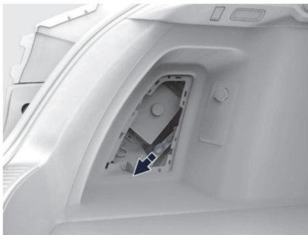
На фото: трос аварийной разблокировки зарядного пистолета.
