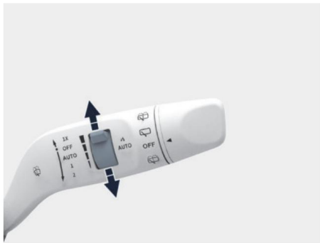
Иллюстрация: Переместите рычаг вверх/вниз, чтобы отрегулировать чувствительность стеклоочистителя.
