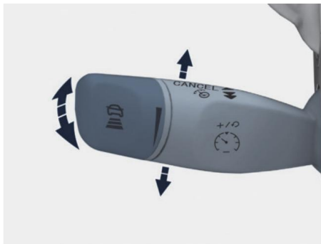
Иллюстрация: регулировка скорости ACC
